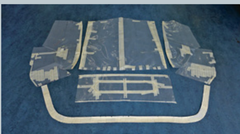
7 Auch die Zwischenschicht aus wasserdichtem Gummi-gewebe will exakt vorbereitet sein.
