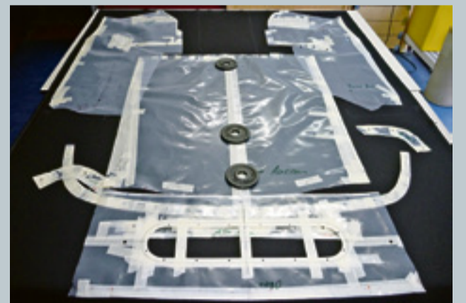
6 Mit den vom Originalverdeck abgenommenen Schnittmustern wird der neue Stoff zugeschnitten.
