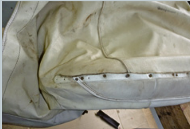
3 Der Dachhimmel ist verfleckt und weist Spuren von Schimmelbefall auf.
