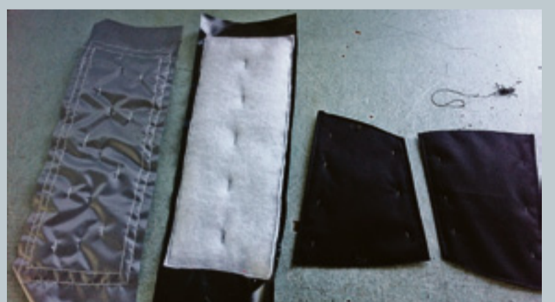
8 Einzelne Elemente bestehen aus mehreren Schichten, welche individuell hergestellt und zusammengesetzt werden.
