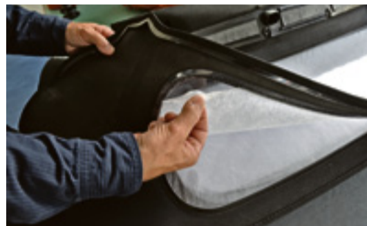
Auch eine komplett neue Plasticscheibe näht der Fachmann direkt ins Verdeck ein (r.).
