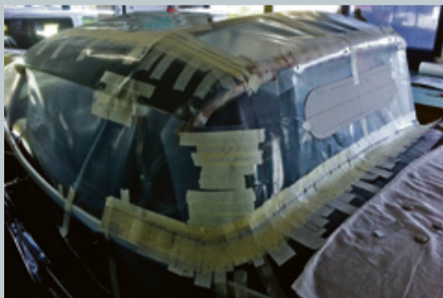
5 Jedes herzustellende Element muss minutiös angezeichnet und am Auto vorplatziert werden.
